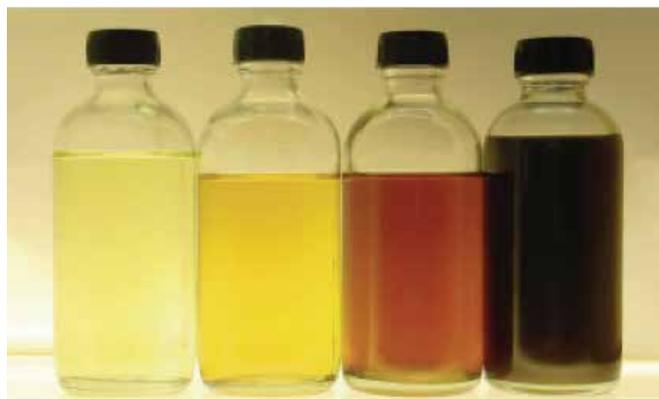
FIGURA 4: La decoloración progresiva ocurre cuando un fluido de transmisión de calor está expuesto al oxígeno a lo largo del tiempo.
