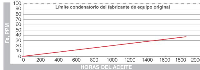
demuestra una protección antidesgaste excelente, con contenido de Fe en < 40 ppm mucho después de las 1600 horas.
