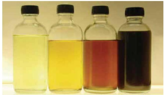
ABBILDUNG 4: Eine zunehmende Verfärbung tritt auf, wenn die Wärmeträgerflüssigkeit im Laufe der Zeit zunehmend Sauerstoff ausgesetzt ist.
